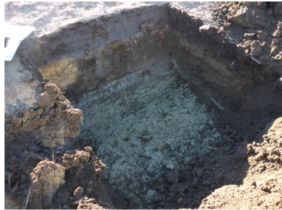
Figur 9. Provgrop i slänten söder om skolbyggnaderna, PG6. Inslag av tegel i fyllningen.
