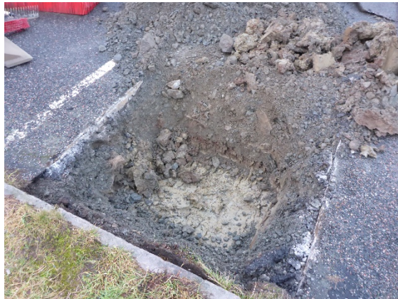
Figur 8. Provgrop inom asfalterad yta (PG11). Bitumenasfalt på bärlagergrus och lera.
