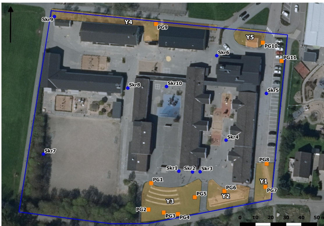
Figur 5. Provtagningsplan för Torslandaskolan. PG är provgropar, Skr är skruvborrningspunkter och Y är ytliga samlingsprovtagning. PG4 har ej grävts eftersom det fanns ett stort antal ledningar i marken.
